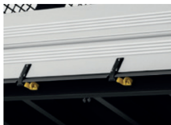
Drážka v bočnici a háky pod valníkom na uchytenie plachty či fixačných pásov.
