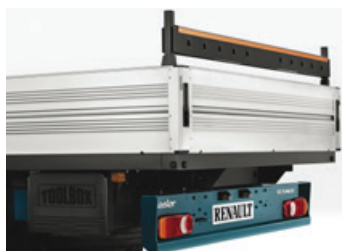
Zadný demontovateľný rám s otvormi na fixáciu nákladu s max. zaťažiteľnosťou 300 kg.
